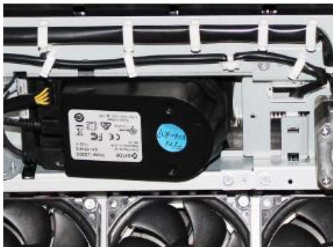
Das X-Rite® Inline-Spektralfotometer automatisiert die Erfassung von XRG-Daten für Kalibrierung und Profilerstellung.
