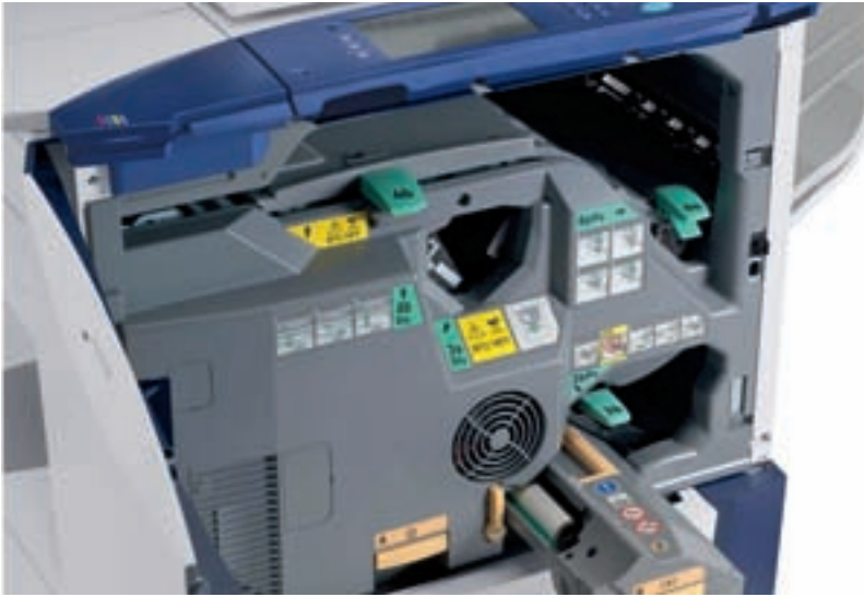
BEDIENERFREUNDLICH: Im Falle eines Papierstaus kann das Papier ganz einfach entnommen werden: der Papierweg innerhalb der Maschine ist beleuchtet.
